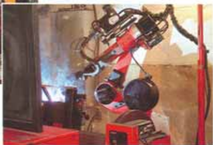
Bei der Farbgebung setzt SüMa auf eine hochwertige Pulverbeschichtung (li.). Für saubere Schweißnähte sorgt ein Roboter (unten).
