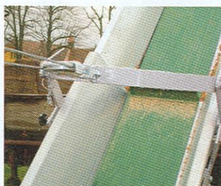
Die Anlenkung ist direkt am Förderband, das so auch in der Höhe verstellt wird.
