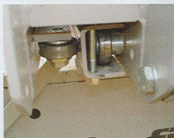
Achtfach kugelgelagert ist der Wipp-tisch. Dementsprechend ist der Kraftaufwand beim Sägen gering.
