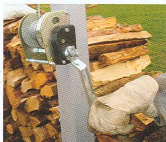
Das Förderband wird mit einer Seilwinde in Arbeitsposition gebracht.
