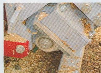
Details am Förderband: Zur Auflage dient ein massiver Bock, die Kette ist lediglich zur Sicherung da (großes Foto). Oben: Ausgefahren wird das Band per Handkurbel und Zahnstangen. Die Lager sind wartungsfrei. Wenn sich das Gummiband dehnt, kann oben und unten nachjustiert werden (unten).
