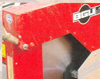
Dieser Deckel sorgt für einen guten Schutz und ermöglicht trotzdem die Zugänglichkeit zum Sägeblatt.
